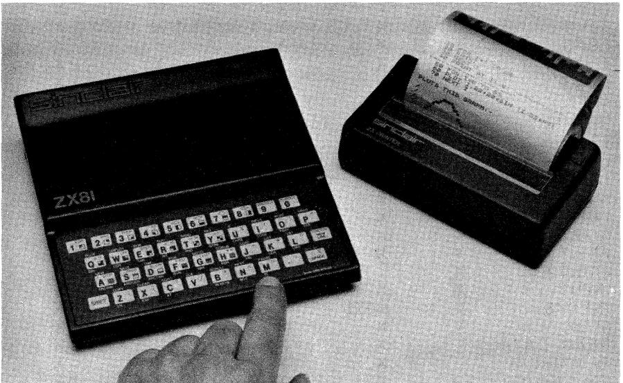
Der leistungsfähige Mikrocomputer Sinclair ZX81. Als Peripherie ist der Sinclair ZX - Drucker erhältlich, der volle Alphanumerik in 32 Anschlägen Breite sowie hochentwickelte Grafiken bietet.
