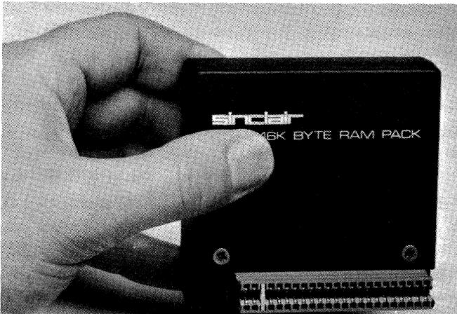
**Der eingebaute 1 K -- byte RAM -- Arbeitsspeicher läßt sich durch Aufstecken eines externen Moduls auf 16 K -- byte RAM erweitern**
