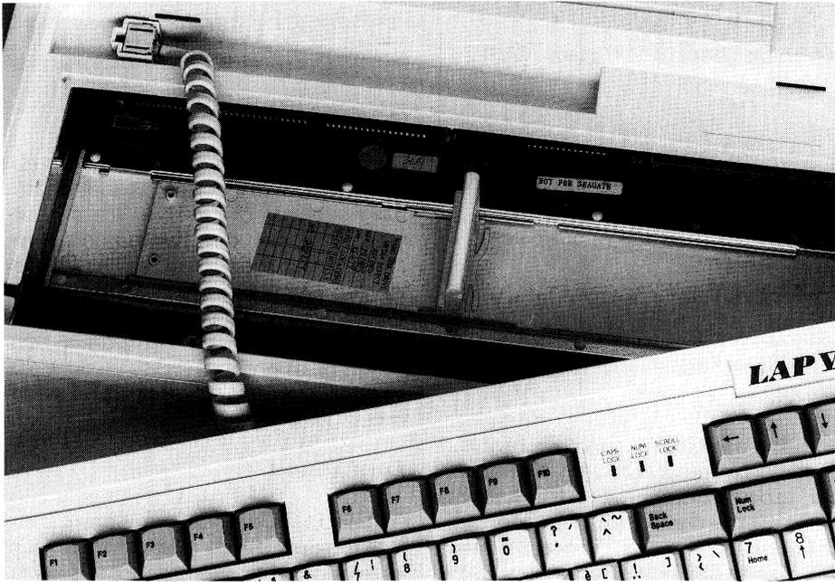
LAP V mit geöffneter Abdeckung für die Steckplätze (unter der Tastatur-Mulde). Der Schieber in der Mitte verleiht den Steckkarten beiderseitigen Halt
