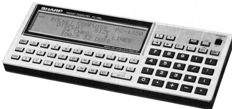
ges schneller ab, als bei vergleichbaren Geräten. Die bis heute erhältlichen Zusatzgeräte sind: CE-201M Speichererweiterung, 8 KB, mit eingebauter Batterie, CE-202M Speichererweiterung, 16 KB, mit eingebauter Batterie und CE-126P Drucker mit 24 Zeichen/Kassetteninterface.
