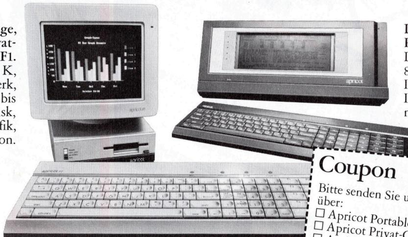
Der sprachgesteuerte Portable. LCD-Bildschirm mit 80 x 25 Zeichen, IR-Tastatur, Farbgrafik, IR-Maus als Option, nur 6 kg.
