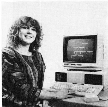
Unser Titelbild zeigt den neuen TANDY 2000, das TRS-80-Erfolgsmodell der Tandy Radio Shack. Dieser PC arbeitet mit dem 80186-Prozessor mit einer Taktfrequenz von 8 MHz und ist damit etwa gleich schnell wie der IBM-PC/AT. Die Floppylaufwerke mit einer Kapazität von je 720 KBytes können auch IBM-PC-Disketten lesen. Das Foto wurde uns freundlicherweise vom Schweizer Tandy-Vertreter, der Rodata AG, Computer Systeme in Dübendorf, zur Verfügung gestellt.
