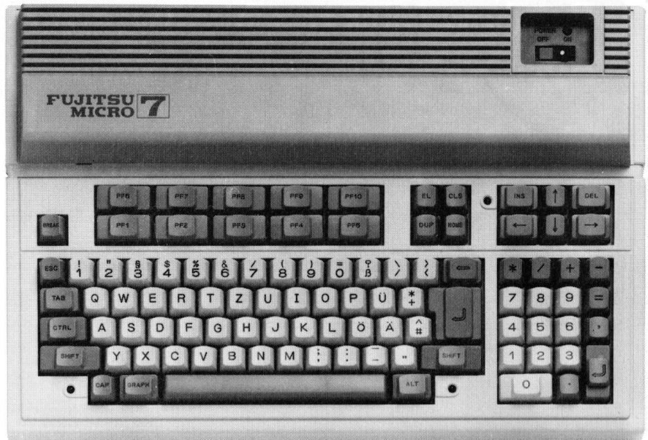
Die Zentraleinheit, die Hard- und Firmware sowie die Tastatur enthält
