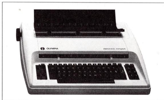
Olympia Compact, elektronische Schreibmaschine mit unserem Interface direkt an den Commodore VC20/64 und an alle Rechner mit einer Centronics parallelen Schnittstelle anschließbar. Komfortables Druckwerk mit 10, 12 und 15 Zeichen/Zoll Teilung (Raumsparschrift), ca. 138 Zeichen/Zeile, Auswahl an Typenrädern, Expresskorrektur im Lift-off Verfahren, Tabulator, Halbschritt und einen elektronischen Andruckregler für mehrere Durchschläge. Das Interface ist auch nachrüstbar.
