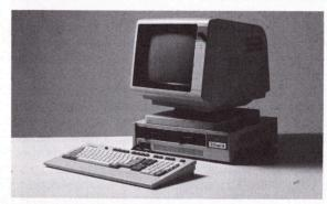
Leistungsfähig mit 8086 (8MHz)
