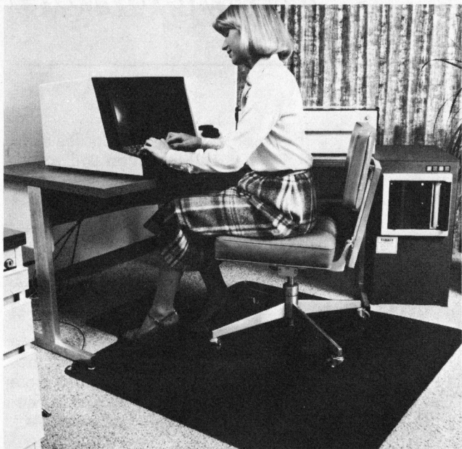
Elektrisch leitende Bodenmatten schützen dieses Terminal gegen elektrostatische Entladungen.
