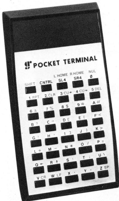
Nach Abdeckung einer Öffnung im Geräteboden werden sechs Dip-Schalter zugänglich mit denen die verschiedenen Betriebszustände eingestellt werden können. Es lassen sich ein oder zwei Stopbits vorwählen, Even oder Odd Parity einstellen und eine Baudrate von 330 oder 110 Baud wählen. Die Wortlänge ist auf 8 bit fixiert und leider nicht programmierbar. Es kann auf RS-232 Protokoll oder 20 mA-Strom-Schleife umgeschaltet werden.
