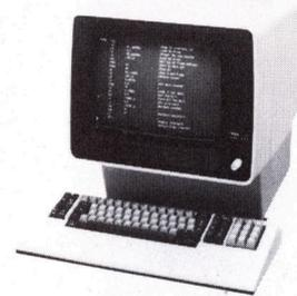
Das TELEX-Bildschirmterminal Modell 310 mit alphanumerischer Tastatur ist bezüglich Design und Preis sehr attraktiv. Es enthält als erstes ASCII-kompatibles Datensichtgerät einen 15-Zoll-Schirm mit 1920 Zeichen Bildinhalt.
