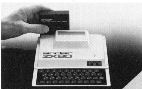
Das 16k-Byte RAM-Erweiterungsmodul ist rückseitig an der Steckerleiste des ZX 80 leicht anzubringen.
