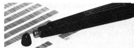
Bild: Der Optical Wand mit dem freigelegten Reflex-Lesekopf.
