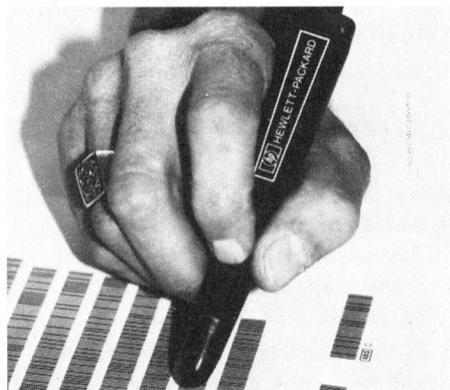
Um zu verhindern, dass der im Lesestift eingebaute Schaltkreis mit seiner Stromaufnahme von etwa 50 mA die Batterien "leerlutscht", empfiehlt sich ein Abschalten in den Betriebspausen. Diese grosse Stromaufnahme geht hauptsächlich auf das Konto der rot strahlenden Leuchtdiode der Reflexlichtschranke.
