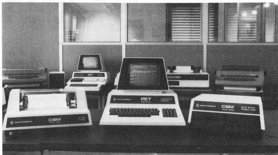
Eine Konfiguration zur Textverarbeitung mit Kleincomputer, Massenspeicher (Floppydisk) und Drucker.
