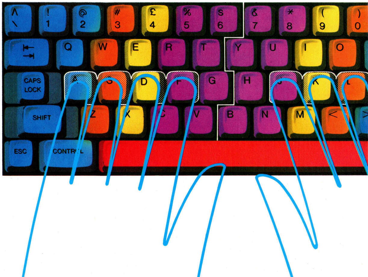
Die Grafik zeigt die Grundstellung der Hände über der Tastatur und die den einzelnen Fingern zugeordneten Tasten. Dabei müssen die Zeige- und kleinen Finger den größten Bereich abdecken.
