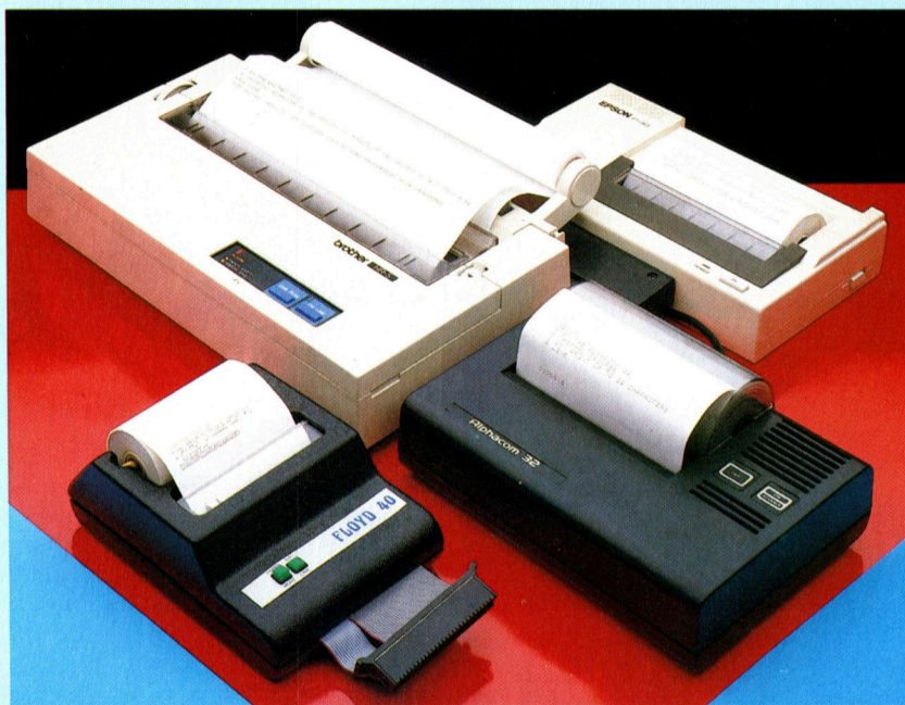
Thermodrucker erfreuen sich trotz einiger systembedingter Nachteile im Heimcomputerbereich großer Beliebtheit. Sie sind billig in der Anschaffung, leise und zuverlässig, brauchen aber teures Spezialpapier und bieten keine hohe Druckqualität.
