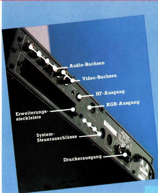
men, sind sie über dieses Interface und die zugehörige Software leicht in das System einzu- beziehen. Mehrere Geräte können zugleich angeschlossen sein: Jedes bekommt einen eigenen Identifizierungscode, so daß über Rechnerbefehle individuelles Ansprechen überaus bequem möglich ist.
