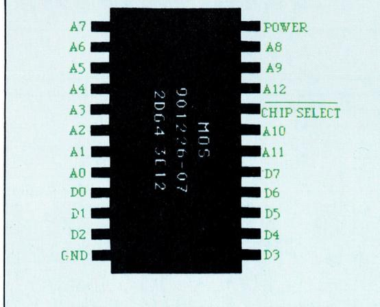
Das hier gezeigte 24-polige 8K-ROM weist eine typische Pinbelegung auf: 13 Eingänge werden zu Adressierung der 8192 Byte benötigt, acht Pins beansprucht der Datenbus, zwei die Spannungsversorgung (Power und Ground=GND), und der Chip-Select-Anschluß dient zur Anwahl dieses speziellen ROMs.
