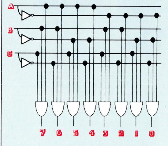
Ein Decoder ist eine Digitalschaltung zur Entschlüsselung von Binärzahlen. Jedem Bitmuster am Eingang ist genau eine Ausgangsleitung zugeordnet, der gezeigte 3-Bit-Decoder muß acht Ausgänge haben. Ausgang 0 wird durch den Eingangswert ABC=000 aktiviert, Ausgang 1 durch 001 usw. bis zum Ausgang 7 für ABC=111.
