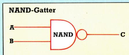
Das Schaltzeichen für den NAND-Gatter entsteht aus dem AND-Symbol, indem ausgangsseitig zur Kennzeichnung der Negation ein kleiner Kreis angefügt wird.
