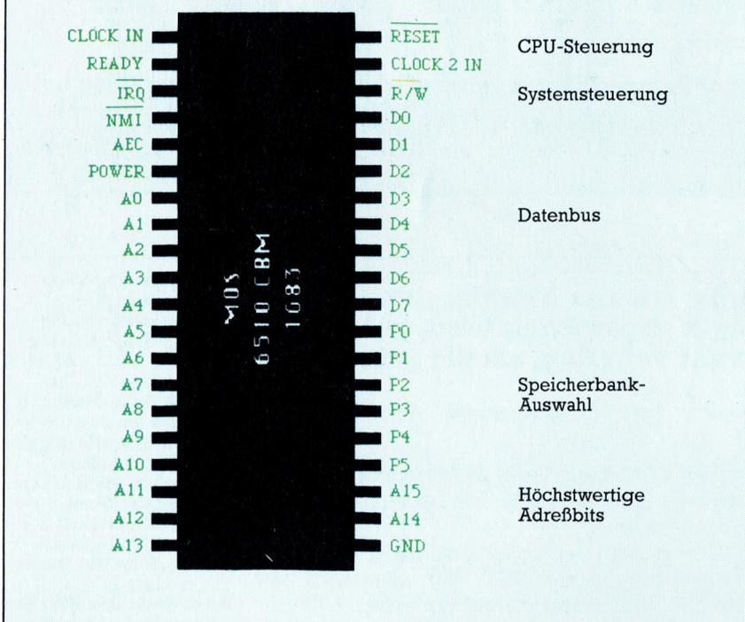
Wie der abgebildete 6510 haben die meisten 8-Bit-Prozessoren 40 „Beinchen“, nämlich 16 für den Adreßbus, acht für den Datenbus, den Rest für Takt- und Steuersignale (einschließlich Interrupt-Eingänge und Schreibfreigabe) sowie zur Spannungsversorgung. Der 6510 ist eine verbesserte 6502-Version. Der Fortschritt besteht wesentlich in einem zusätzlichen Datenregister für die Cassetten-Ein/Ausgabe.
