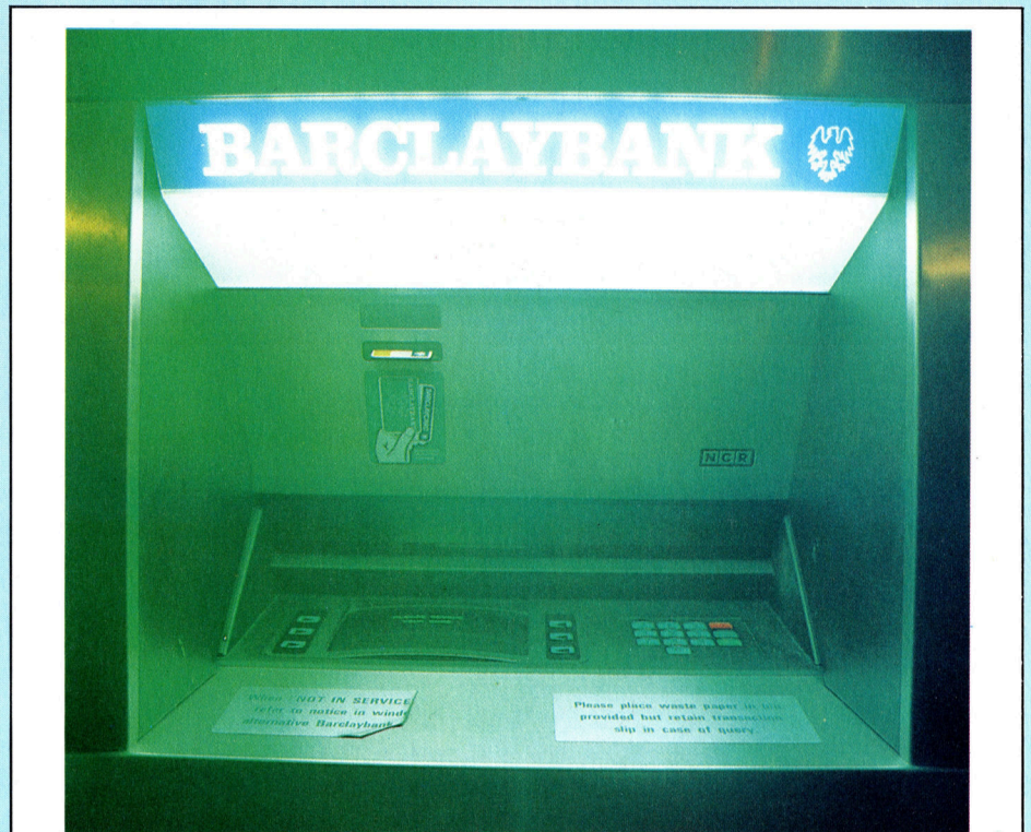
Verbreitet ist die Verwendung von Magnetkarten bei Bargeldautomaten. Der Magnetstreifen auf der Karte enthält eine Codenummer, die elektronisch gelesen und mit den Ziffern verglichen wird, die der Benutzer eintastet. Stimmen die Zahlen überein, wird der Zugang zur Geldausgabe freigegeben.
