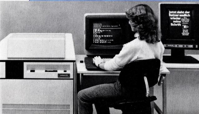
Das Foto zeigt ein modernes Fotosatzsystem auf Laserbasis. Es ist ein typisches computergesteuertes System und kann bis zu 368 000 Zeichen pro Stunde erzeugen.
