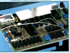
Die beiden Leitungen, die hier über der Leiterplatte des Sinclair Spectrum liegen, führen zu einer separaten Reset-Taste und verwandeln den Spectrum in einen Spectrum+. Die (kostspielige) Alternative für diesen typischen "Kludge" hätte darin bestanden, eine neue Platine zu entwerfen, um die zusätzlichen Leiterbahnen unterzubringen.
