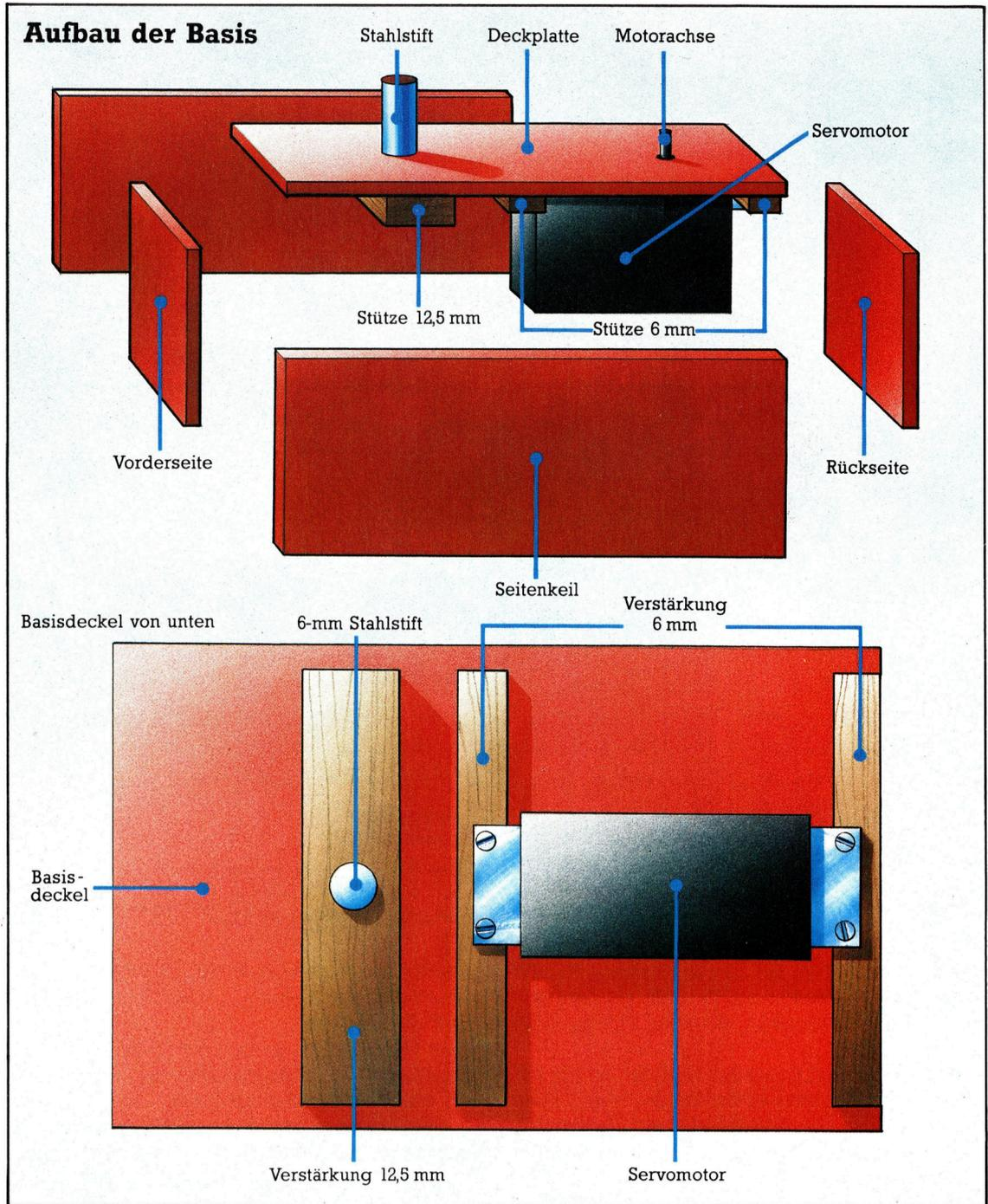
6 mm haben. Solche Lager erhalten Sie im Modellbau-Geschäft. Als Achse für das Lager dient ein 25 mm langer, 6 mm starker Stahlstift, der fest mit der Basis verbunden und durch das Kugellager hindurchgesteckt wird.
