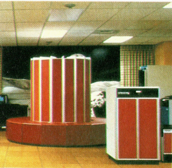
Das Erscheinungsbild des Cray-1 ist unverwechselbar. Der Computer befindet sich in einem kreisförmig angeordneten Gebilde. Die Stromversorgung liegt unter den runden Sitzbänken.
