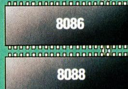
**8086 und 8088:** Der 8088 ist eine abgemagerte Version des 8086, die mit älteren Zusatzbausteinen funktionsfähig ist und deshalb eine Zeitlang sehr beliebt war. Der Einsatz beim Sirius und beim IBM PC machte den 8088 zum verbreitetsten 16-Bit-Prozessor. Bei den meisten neuen Rechnern wird inzwischen der leistungsfähigere Chip 8086 verwendet.
