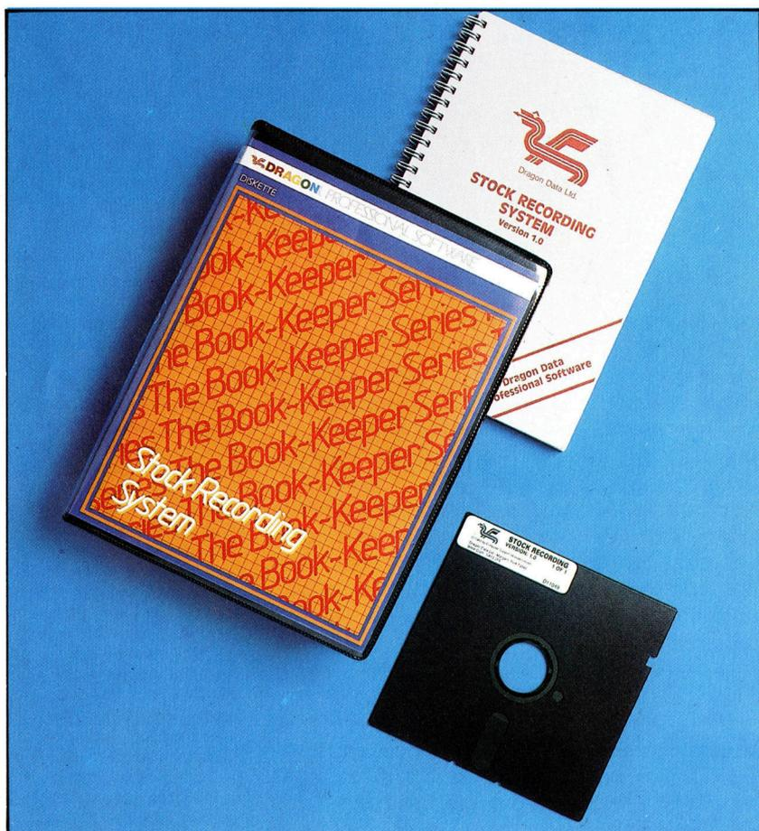
**Das Stock Recording System ist eines der Anwendungsprogramme für den Dragon 64, das unter dem Betriebssystem OS9 funktioniert. Dieses Betriebssystem wurde von Dragon aus dem UNIX-System entwickelt und enthält Möglichkeiten des Multi-Programming und Multi-Tasking.**
