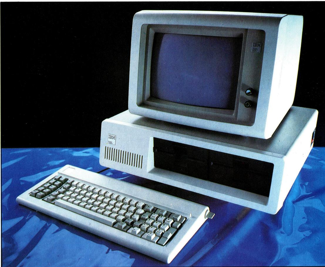
Das Design und die Auslegung des IBM PC zeigen die große Erfahrung der Firma auf dem Gebiet der Computer und Büromaschinen: Der PC ist solide und nach ergonomischen Gesichtspunkten konstruiert. Die drei Hauptgeräte – Tastatur, Prozessorgehäuse und Monitor – sind frei beweglich und können beliebig angeordnet werden. Die Standardausführung der Maschine enthält einen monochromen Bildschirm; ein Farbmonitor wird ebenfalls angeboten.
