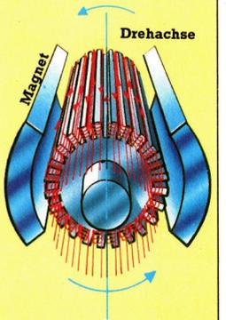
Bei einem einfachen Elektromotor wird ein dem des Stators entgegengesetztes Magnetfeld erzeugt. Dies bewirkt die Drehung.
