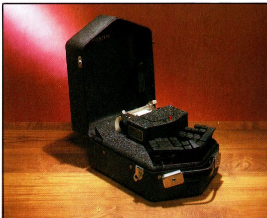
Wenn Gespräche mitgeschrieben werden sollen, der Stenograf aber der Geschwindigkeit des Sprechers nicht folgen kann, wird häufig eine Maschine eingesetzt. Sie ist als Stenorette bekannt. Diese Stenografiermaschine verwendet eine besondere Kurzschriftversion des phonetischen Alphabets.
