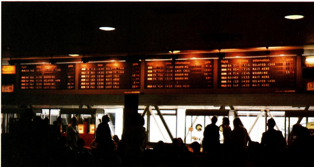
Die Anzeigetafeln für Ankunft und Abflug sind die vielleicht am stärksten ins Auge fallenden Computersysteme eines Flughafens. Diese elektromechanischen Geräte werden von dem Zentralrechner, sobald neue Informationen verfügbar sind, fortlaufend bearbeitet.
