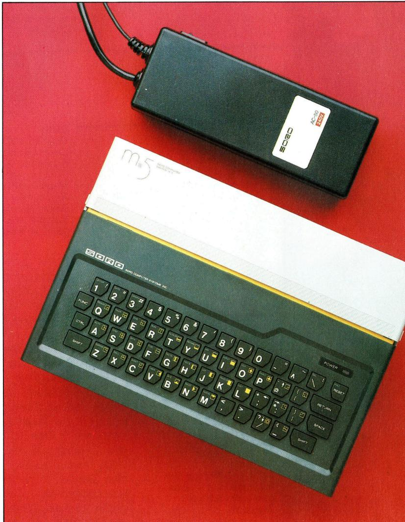
Die Tastatur des Sord M5 besteht aus Gummitasten. Über insgesamt 55 dieser Tasten können mit Hilfe einer Funktionstaste alphanumerische Zeichen, grafische Symbole oder ganze BASIC-Befehle eingegeben werden. Hält man die Tasten heruntergedrückt, so wiederholt sich das entsprechende Zeichen automatisch (Auto-Repeat-Funktion).
