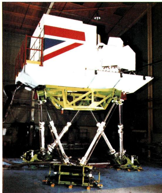
Von außen erscheinen Flugsimulatoren wie unförmige Kästen auf angewinkelten hydraulischen Stelzen. Das Innere entspricht jedoch exakt dem Cockpit eines modernen Linienflugzeuges.
