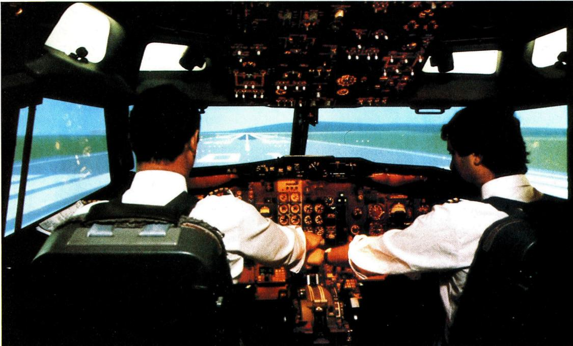
„Bravo Alpha drei zwei fünf, Start auf Landebahn eins zwei ist freigegeben. Windgeschwindigkeit eins fünf Knoten in Richtung Null fünf. Melden wenn 1000 Meter erreicht“, könnte die Startfreigabe der Flugsicherung lauten, doch die Startbahn dieser Boeing 737 besteht nur aus digitalen Impulsen in dem Computersystem des „Rediffusion Novoview SP3“ Flugsimulators.
