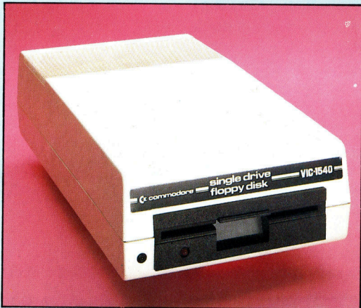
1540 Diskettenstation Dieses Diskettenlaufwerk mit einem Schacht wird seriell an den Commodore 64 angeschlossen. Eine 5 1/4 Zoll Diskette hat eine Speicherkapazität von 170 KByte, 2 Sekunden ist die Zugriffszeit.
