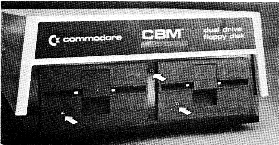
Figur 1-27. Leuchtdioden auf der Frontseite von Floppy Disk-Speichern
