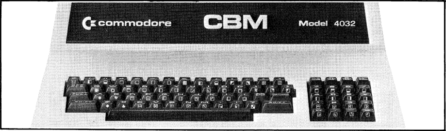
Figur 1-13. Große Schreibmaschinen-Tastatur mit Graphiksymbolen (Serien CBM 3001, CBM 4001)
