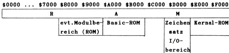
Im gerade eingeschalteten Zustand sind alle diejenigen Bereiche lesbar, die in diesem Schema von unten sichtbar sind. Also:
