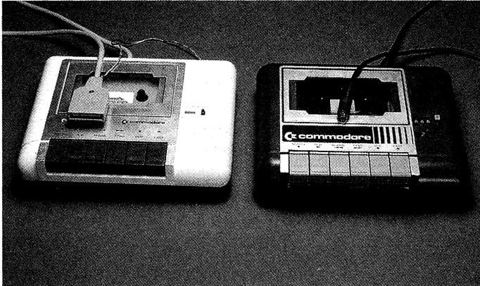
*Bild 2.1: Die Datasette ähnelt einem Kassettengerät.*
