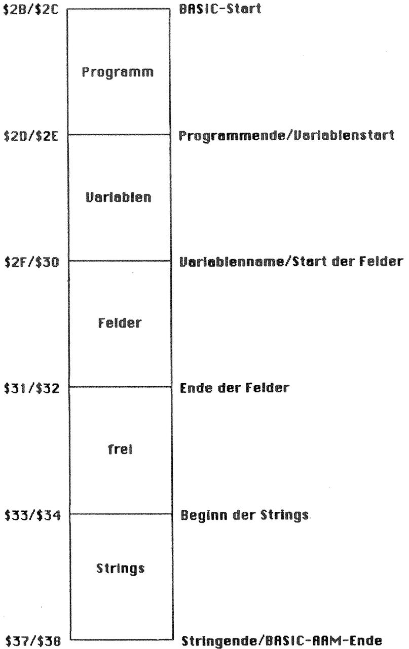
Nach dem Einschalten des Rechners liegt der BASIC-Start bei \$0801 = 2049 und das BASIC-Ende auf \$A000 = 40960. Wenn Sie eine Programmzeile
