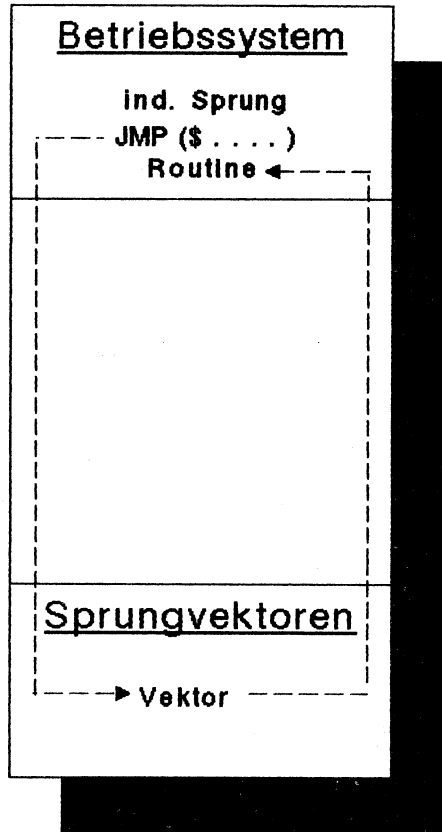
Abb. 3.1.2: Funktion der Sprungvektoren
