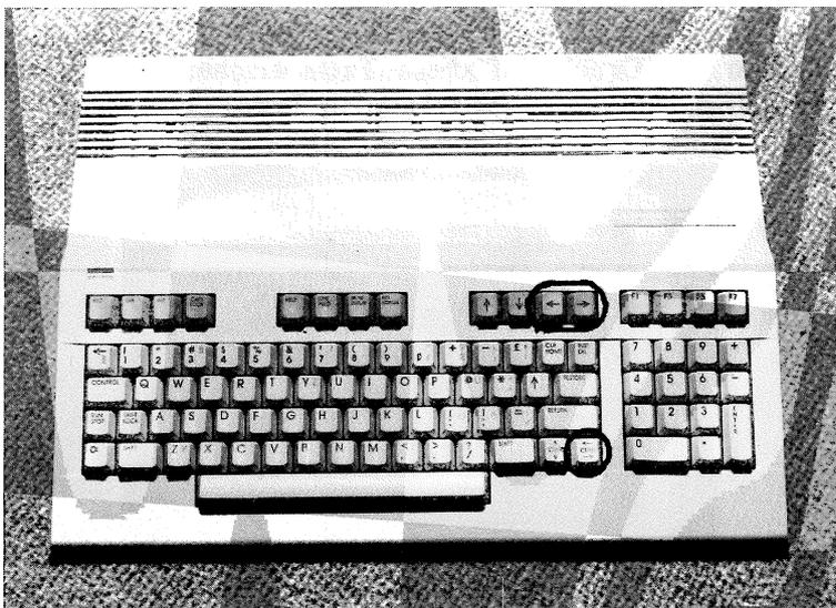
Diese Taste befindet sich unten rechts auf der Tastatur. Sie ist beschriftet mit der Abkürzung für Cursor (CRSR) und den Pfeilen nach rechts und links. Mit dieser Taste können Sie nun den CURSOR auf dem Bildschirm nach rechts oder links verschieben. Betätigen Sie nun diese Taste 20 mal, so wandert der Cursor 20 Stellen nach rechts und blinkt wieder geduldig unterhalb dem 'S' von 'RIGHTS'.
