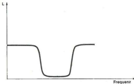
Das Kerbfilter (Notch reject Filter) läßt alle Frequenzen oberhalb und unterhalb der Grenzfrequenzen durch außer den Frequenzen, die im Bereich des Bandpaßfilters liegen.
