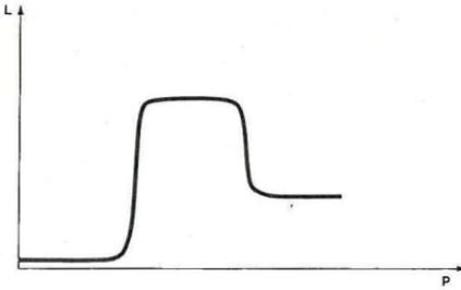
Durch das Kombinieren von Bandpaß- und Hochpaßfilter werden alle Frequenzen oberhalb der Grenzfrequenz hervorgehoben.
