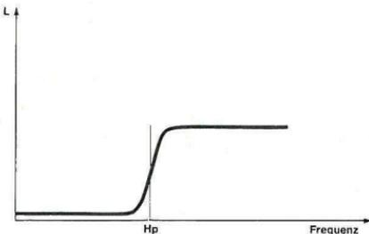
Analog dazu läßt der Hochpass nur Frequenzen durch, die oberhalb der Grenzfrequenz liegen. Die darunterliegenden werden abgeschnitten. Der Ton klingt dünn bis scharf.
