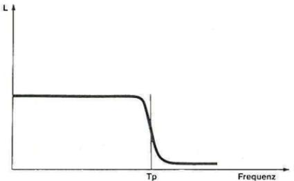
Der Tiefpass schneidet alle Frequenzen ab, die oberhalb der Grenzfrequenz liegen und läßt alle Töne durch, die unterhalb liegen. Der Ton klingt voluminös bis dumpf.
