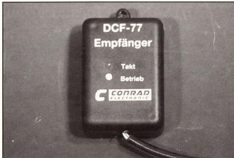
Seit einigen Jahren schon wird in Mainflingen bei Frankfurt/M. das offizielle Zeitsignal über Langwelle ausgestrahlt. Erzeugt wird es von einer Atomuhr, die zu den genauesten der Welt zählt (über die Abweichung von 1 Sekunde in 1 Million Jahren kann man durchaus hinwegsehen).
