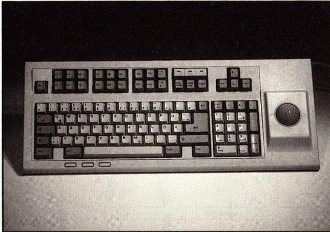
Die IBM-AT-Tastatur wird mit Hilfe eines Interfaces an den AMIGA angeschlossen.
