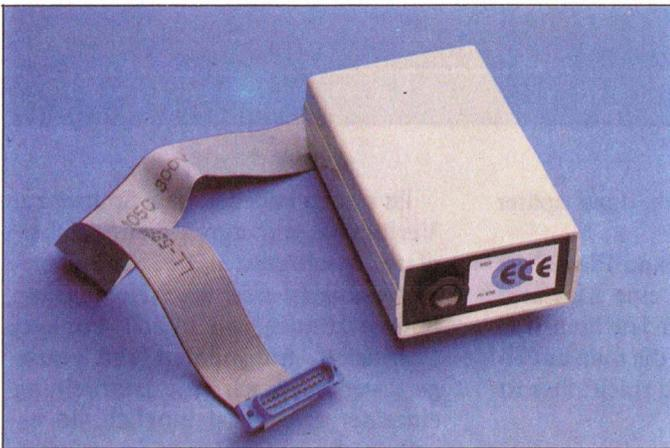
ECE-MIDI-Interface stellt die Verbindung zwischen dem AMIGA und einer MIDI-kompatiblen Anlage her. Der Anschluß erfolgt beim AMIGA am seriellen Port (RS-232). Als Ausgang werden drei DIN-Buchsen (In.Thru.Out) angeboten. Der serielle Port des AMIGA ist durchgeschleift und mit einem Schalter versehen. Dadurch kann auch weiterhin ein serieller Drucker oder ein Modem betrieben werden. (PDC, Bad Homburg, DM 140,-)
